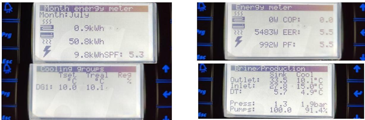
Figura 8. Monitorizarea functionarii pompei de caldura in regim de racire
